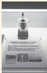
写真2) 短波標準電波の送信に使用された真空管
