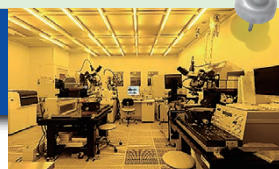
リソグラフィ等で微細構造パターンの形成を行うクリーンルーム（イエロールーム）
