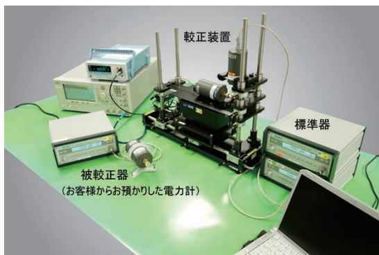
図1 高周波電力計較正装置 較正依頼者（お客様）からお預かりしたテラヘルツ波用の電力計を較正するための装置です。導波管の寸法に応じて装置を整備し、サービスを行っています。
