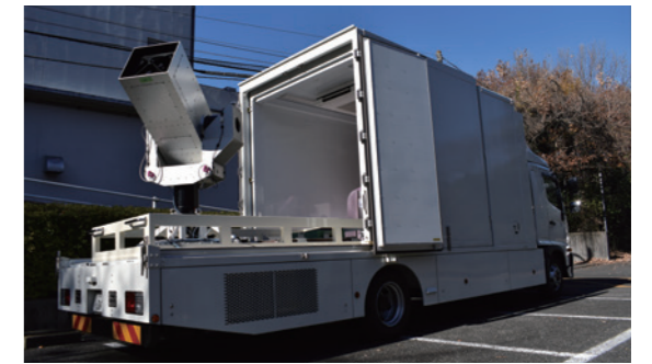
図2 衛星からの量子信号を安定して受信し、かつ様々な場所で展開可能な可搬型光地上局
