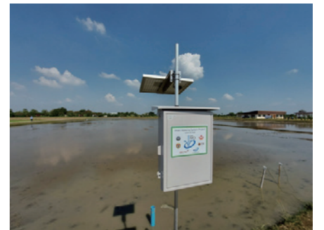
図 各種センサーなどIoT技術を用いた水田の水管理システムの実証実験(タイ・チェンマイ地域)
