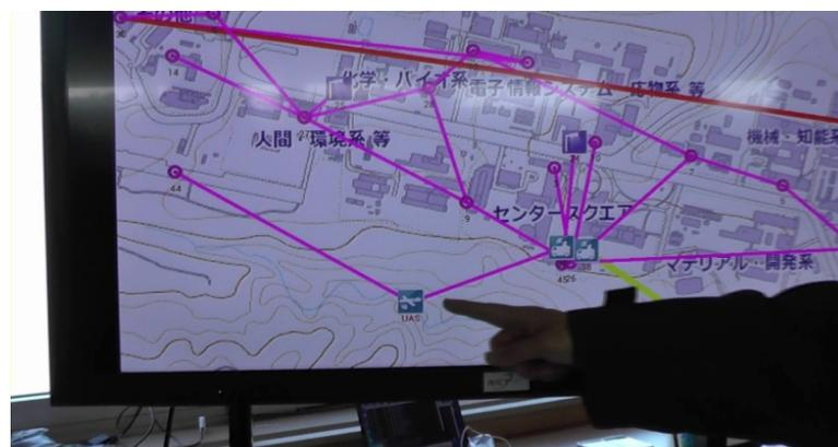
無人飛行機経由でネットワークが繋がった様子を地図上でリアルタイム表示(指で示しているアイコンが無人飛行機中継局)
