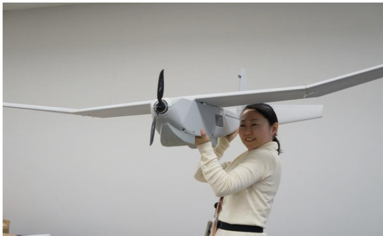
UASの外観(翼長:2.8m、全長:1.4m、機体重量:5.9kg、ペイロード:5kg、飛行時間:2~4時間、耐風速:12.9m/s、電動、最高飛行高度:約4000m、飛行距離:数10km、手投げ離陸方式)
