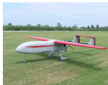
B-II(富士インバック) 翼長3.2m, 航続距離500km レシプロエンジン 1000~2000万円/システム
