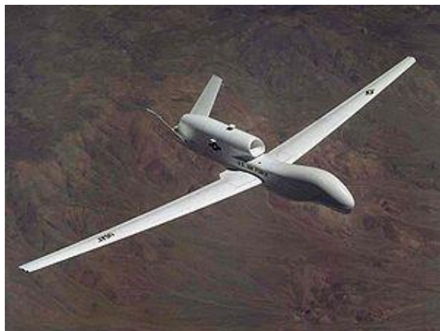
Global Hawk (米Northrop Grumman) 翼長34.5m, 航続距離 12,000km ターボファン, 1000億円以上/システム
