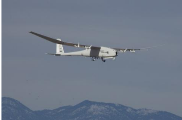
Global Observer (米AeroVironment) 水素燃料により成層圏に1週間の滞空をめざす
