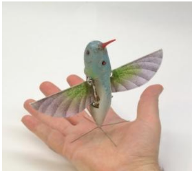
Nano Humming Bird UAV (米AeroVironment) ハチドリを模した羽ばたき型超小型偵察用UAV
