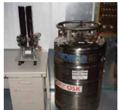
図3 液体ヘリウム容器 (右) と SSPD システム (左)。
