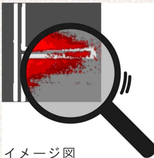
図1. 電界カメラのイメージ図。高周波回路(T字型)から電気信号に応じた電界(赤色)が染み出し、それがリアルタイム撮像装置によって視覚的に映し出されています。虫メガネの形態は将来の夢を表したものであり、現状では原理実証実験用の装置が用いられています。図中の電界分布は実測結果です。
