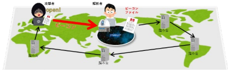
②サイバー攻撃誘引基盤STARDUSTによる攻撃者誘引実験 攻撃者がビーコンファイル（模擬情報）を開発すると追跡用のビーコンを発信（注：図と実際の実験結果は異なる）
