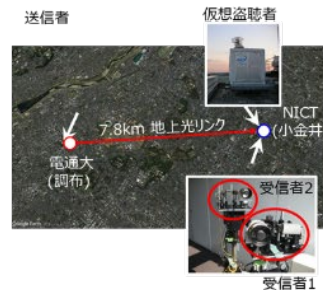
光空間通信テストベッドにおける物理レイヤ暗号実証実験
