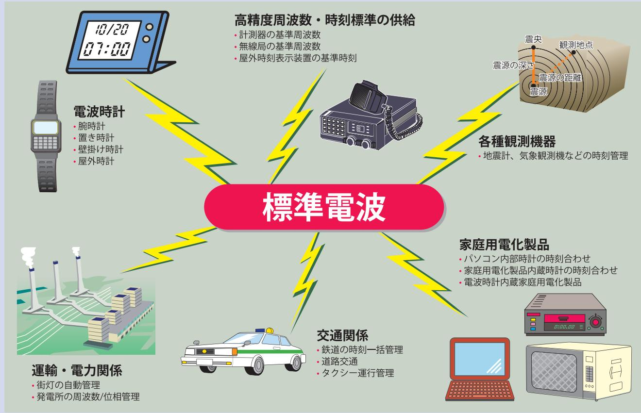
次の受信機会までは、通常のクオーツ時計として動きます。時刻合わせ精度は、日本標準時に数ミリ秒程度の誤差で同期が可能です。あらかじめ電波を受信しやすい場所を選べ、その場所に電波時計を置くとより確実に時刻合わせが行えます（受信と時刻合わせに要する時間は数分程度）。
