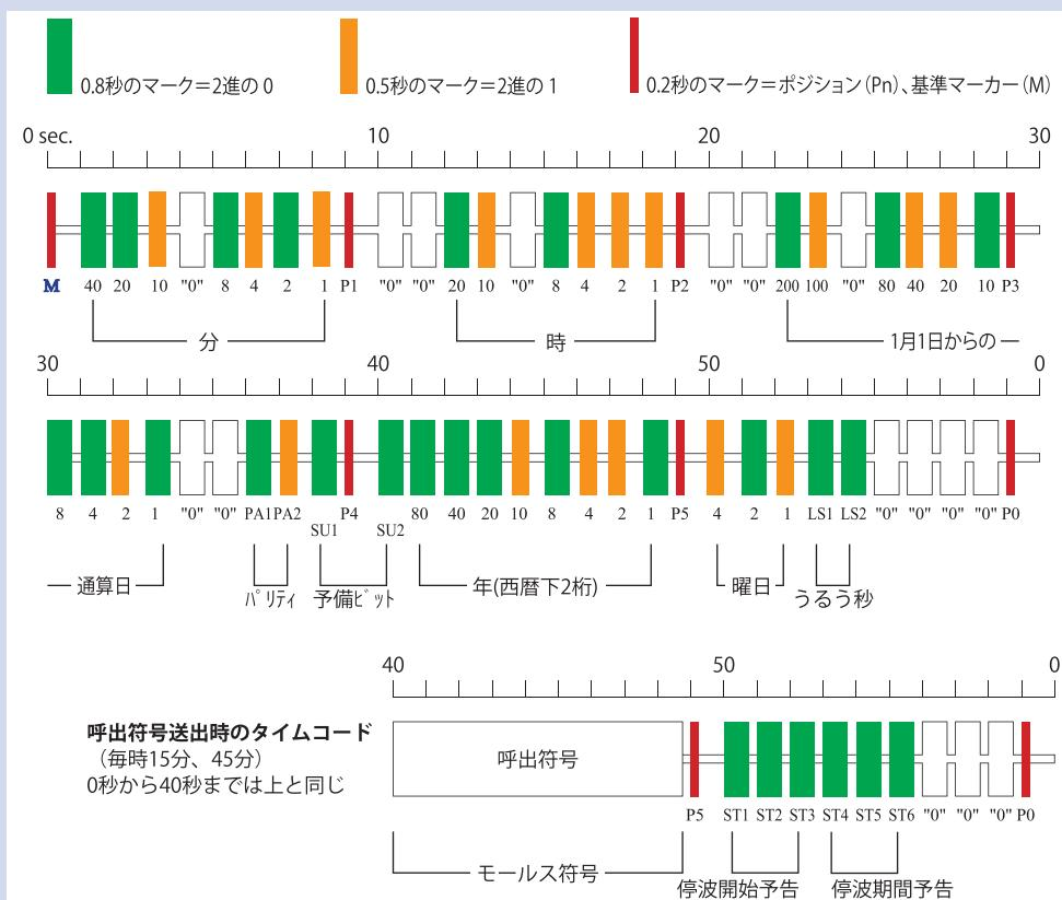
タイムコードは60秒間かけて基準マークー**M**の位置の時刻を知らせます。左の図では、例として2016年6月10日(通算162日目)金曜日の17時15分(1ヶ月以内うるう秒なし)を表しています。
