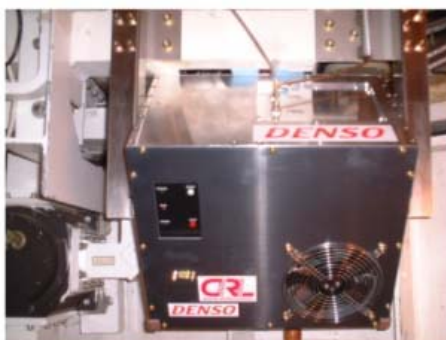
34mパラボラに設置した冷却受信機に高温超伝導(HTS)フィルタを付加したシステム
