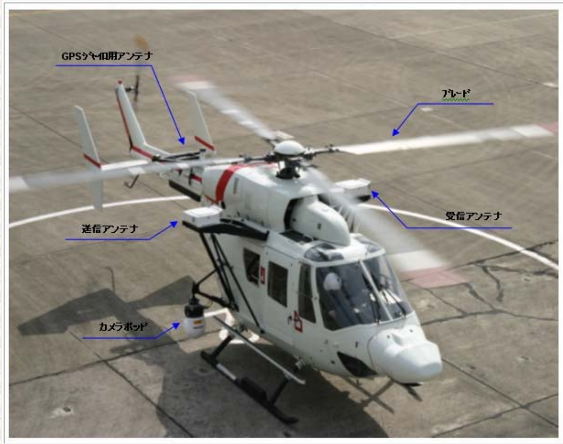
図2: 衛星通信システムおよびカメラを搭載したヘリコプターの外観
