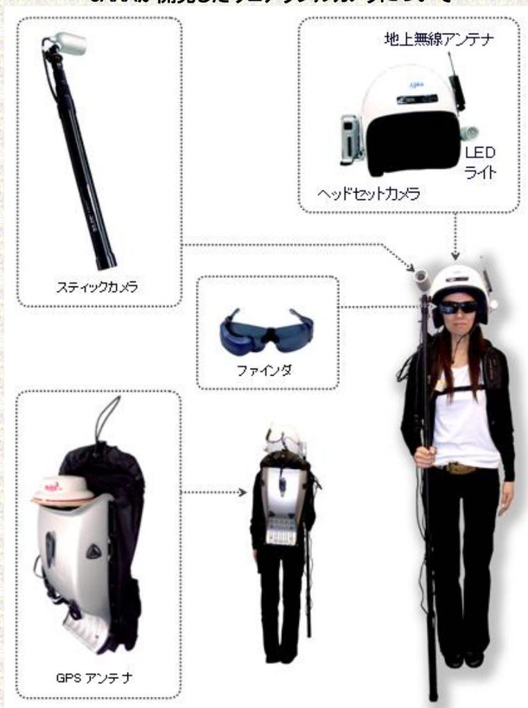
被災現場に到着した作業員はウェアラブルカメラを装着します。
