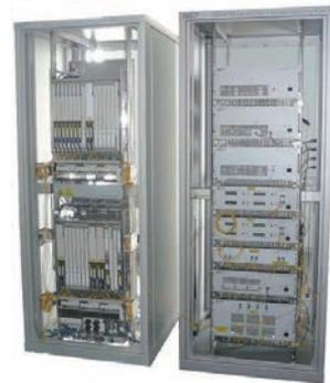
図 2.1.14 光パケット・光パス統合ノード装置
