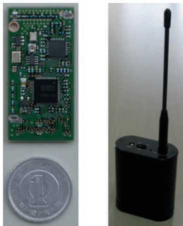
図2.2.11 左：Wi-SUN 無線モジュール、右：無線モジュールに電池ボックス、インタフェース部をつけた無線機
