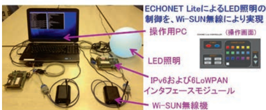
図2.2.12 上：ECHONET Lite 用 Wi-SUN プロファイルのプロトコルスタック、下：ECHONET Lite 用 Wi-SUN プロファイルの動作実証
