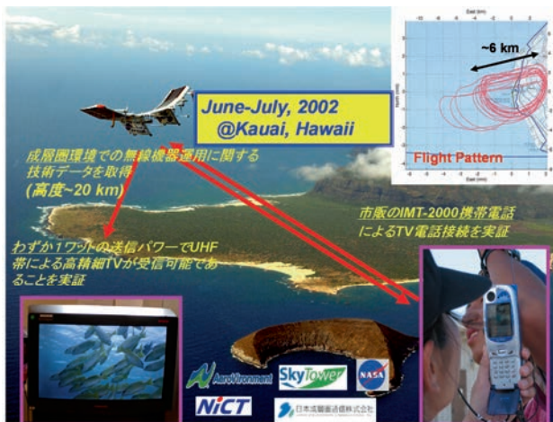
図2.2.4 NASAの高高度滞空型ソーラープレーンによる携帯電話中継とデジタル放送の実証
