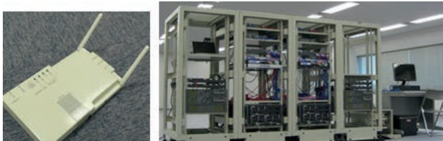
図2.2.6 左：ヘテロニアス型コグニティブ無線基地局 右：コグニティブワイヤレスクラウド用サーバ
