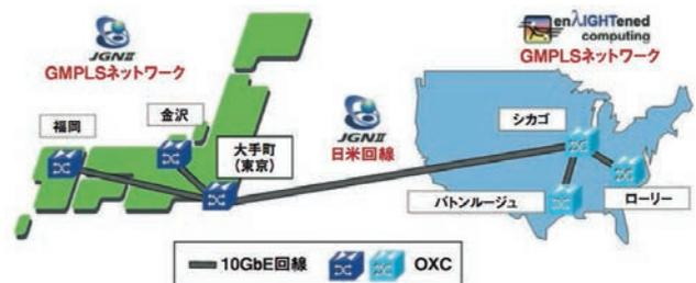
図2.6.4 日米のマルチドメイン間でのGMPLS相互接続実験の構成
