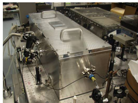
図2.14.5 広帯域テラヘルツ波センシングシステム 真空を保持できる金属箱の中にテラヘルツ電磁波の発生検出光学系が配置してある。
