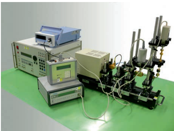
図2.17.21 Dバンド(110~170 GHz)の電力較正系
