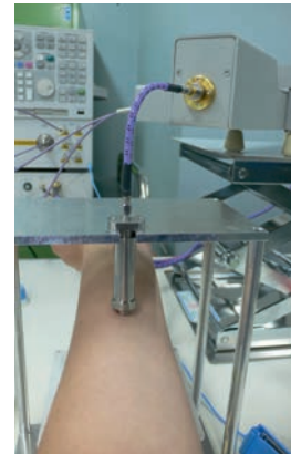
図2.17.19 同軸プローブを用いた電気定数測定系
