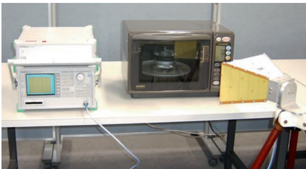
図2.17.2 電子レンジ雑音に対する APD 測定
