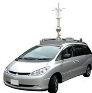
図2.17.1 3軸等方性アンテナを搭載した電磁環境モニタリング車
