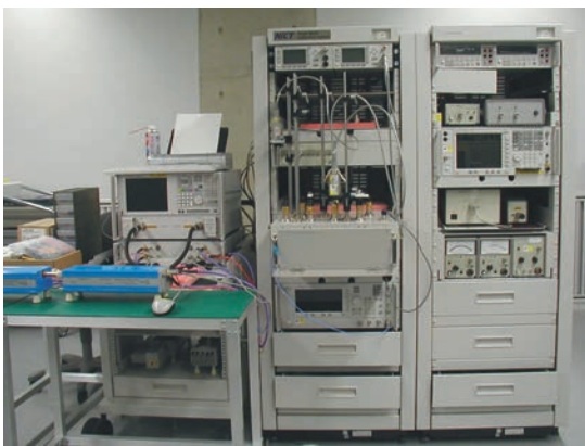
図2.17.5 周波数上限を拡張した電力較正系
