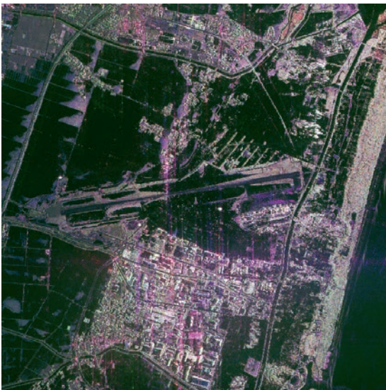
図2.15.11 東日本大震災の翌日の仙台空港周辺(5km × 5km)航空機搭載 SAR (Pi-SAR2) により観測したもの。図の中央部に空港滑走路、右側は太平洋。
