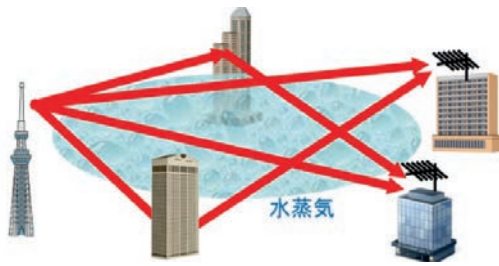
図2.17.17 地上デジタル放送波による水蒸気量の推定
