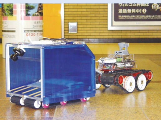
図2 ● 国際レスキューシステム研究機構等と共同開発中の通信ケーブル敷設ロボット
