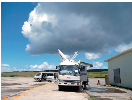
図3 ● 28GHzのアップリンクに影響する強烈な降雨(スコール)にしばしば見舞われ、地面から湧き出す硫黄ガスの中で中継を行うNICT車載局
