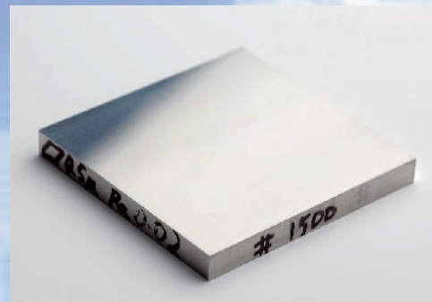
図1●ナノインプリント用に加工したステンレスプレート (2インチ角、厚さ5mm、表面精度0.5 \mu m)
