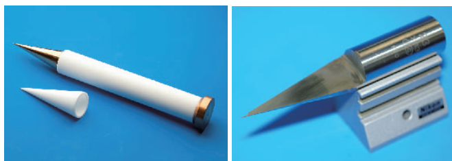
図5●テフロンコーティング(白い部分。外径36mm、全長325mm)と、自作した、円錐の内部をくり抜くための工具
