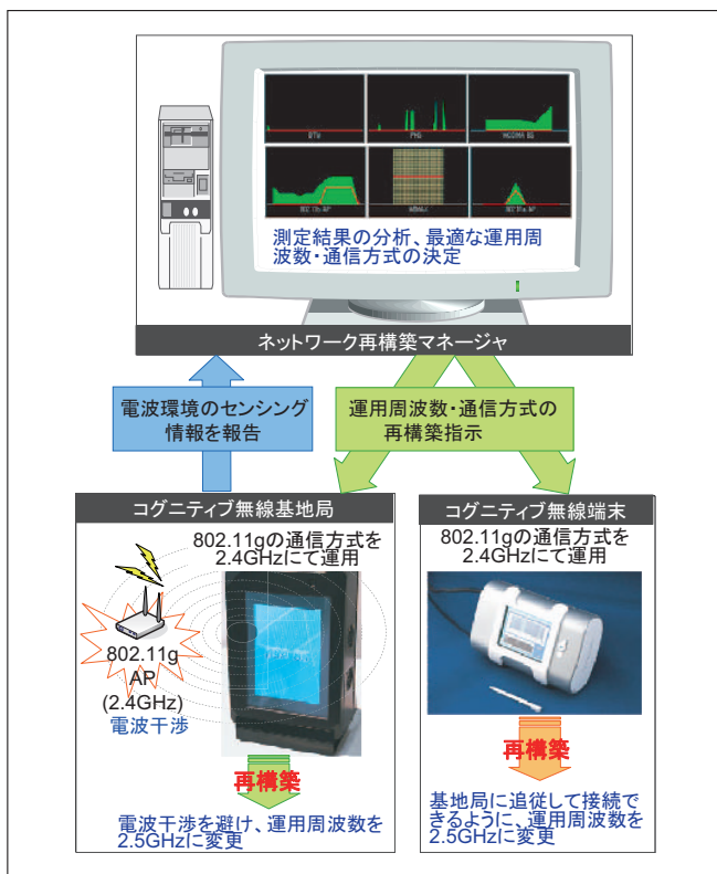
図4 ●電波環境センシングに基づき運用周波数と通信方式(PHY/MAC)の再構築が可能なコグニティブ無線システム（周波数共用型の一例）
