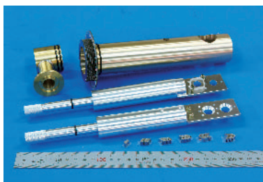
図3●テラヘルツ分光器用 試料ホルダー(全長255mm)
