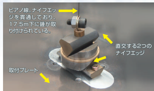
図3●フーコーの振り子の支点機構
