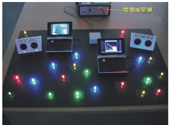
図5●面状通信媒体上の任意の位置に置かれている、スピーカー、LEDライト、モニターなどを含む小型装置への非接触給電の様子
