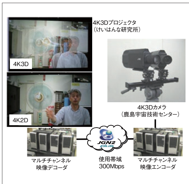
図4●JGN2plusを用いた4K3Dライブ映像伝送
