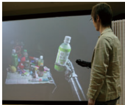
図3●4Kロボットビジョンの撮影映像(3D操作グローブで遠隔操作)
