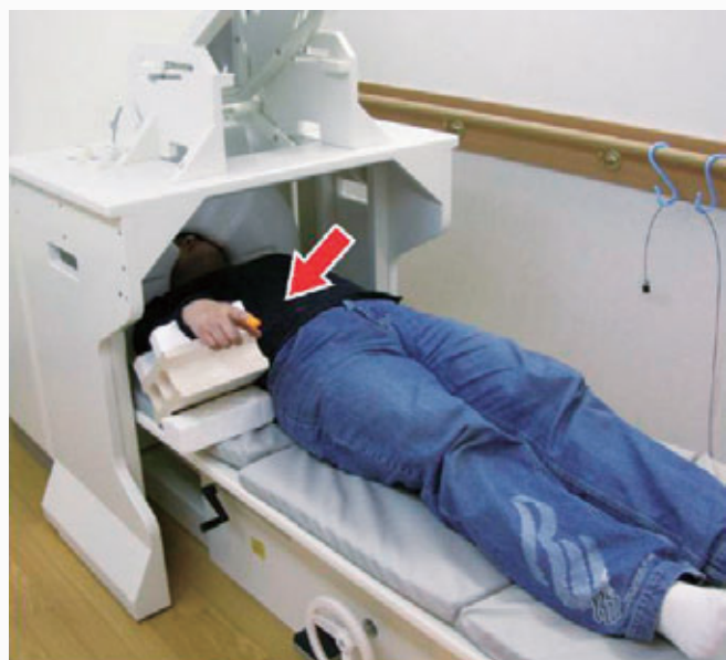
図1●MEG装置の外観と、これを使った実験風景。矢印は人差し指の先端を示す。
