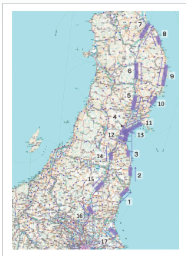
図1●2011年3月12日の飛行パス(地図提供：国土地理院) 紫の長方形の部分が観測実施場所を表し、数字は観測の順序を表す。なお、管制からの指示により一部のパスにおいては観測が見送られた。
