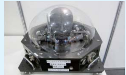
電波を吸収する人体頭部の特性を模擬製作したファントムを用いて、電波干渉量の測定を行う。
