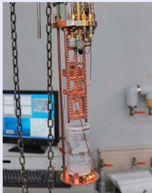
図3●希釈冷凍機内の超伝導量子ビット測定環境
