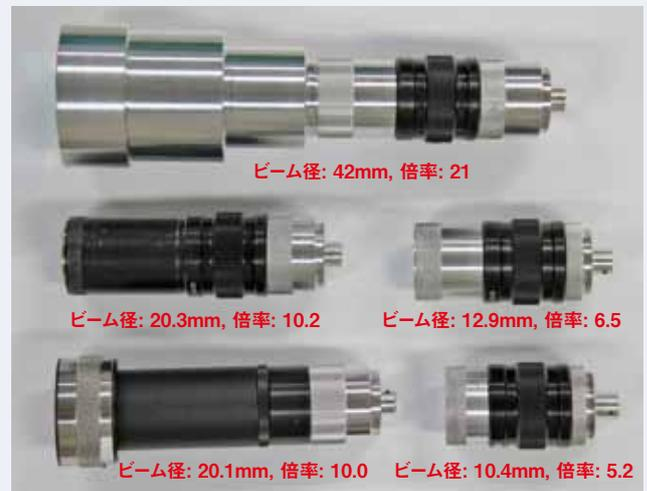
図3●試作した光アンテナ（倍率5.2倍から21倍まで、ビーム直径10mmから42mmまでの5種類）
