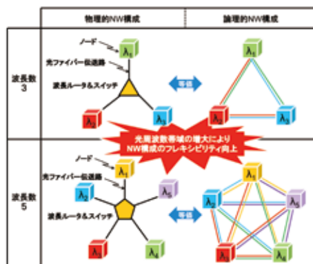
図2●利用可能な光周波数帯域の増加によるネットワークのフレキシビリティ向上 従来よりもさらに広い光周波数帯域にわたって波長ルーティングやスイッチングを組み合わせることで、アクセス系やデータセンター内光ネットワークで、より多くのノードを、より高い設計自由度で構築できることが期待されます。
