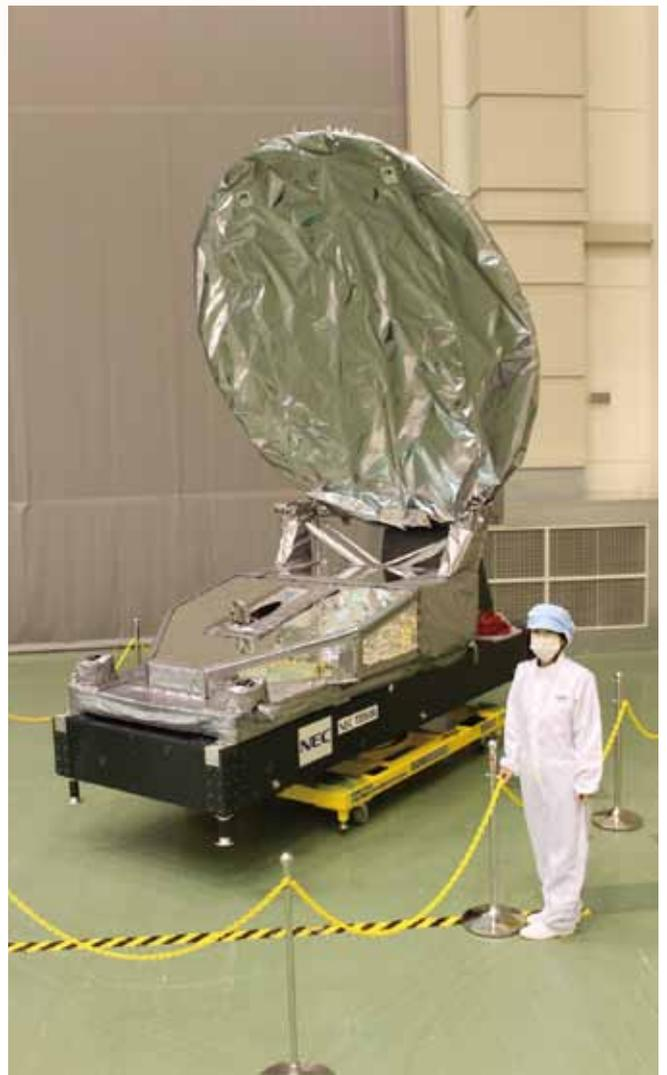
図1 CPRのエンジニアリングモデル(写真提供: JAXA)
