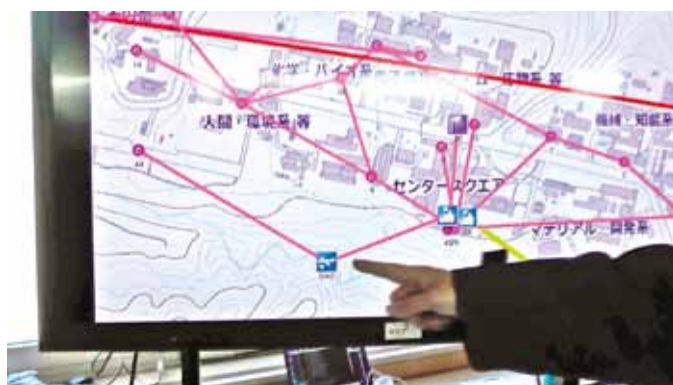
図5 無人飛行機経由でネットワークが繋がった様子の地図上でのリアルタイム表示(指で示しているアイコンが無人飛行機中継局)
