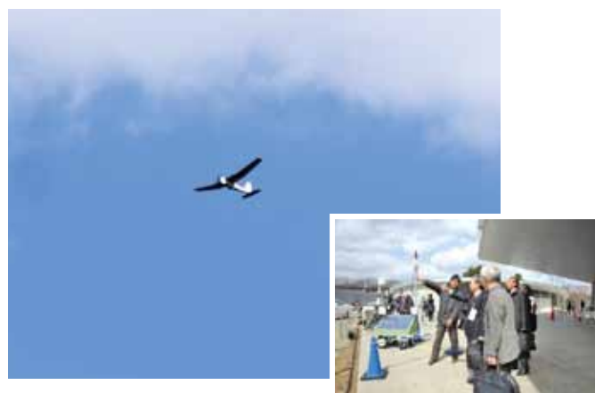
図4 自律で巡回飛行する無人飛行機とそれを見上げる公開実証実験見学者(後ろにあるのは太陽電池付き可搬型メッシュネットワーク基地局)
