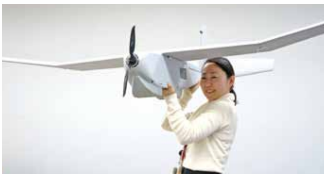
図1 小型無人飛行機の外観 (翼長2.8m、全長1.4m、重量5.9kg、飛行時間2~4時間、耐風速25ノット、電動、手投げ離陸方式)
