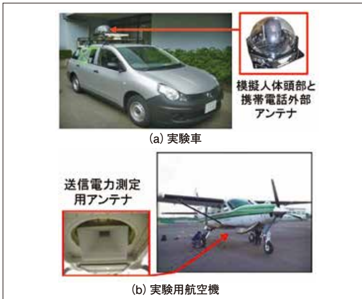
図3 地上携帯電話の送信電力測定
