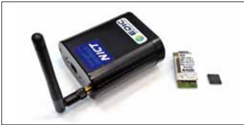
図2 NICTで開発したECHONET Lite対応Wi-SUN無線機(左:無線機、右:無線機に搭載されている無線モジュール)
