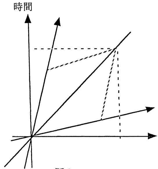
第A9図 時間、空間の変換と光速不変
