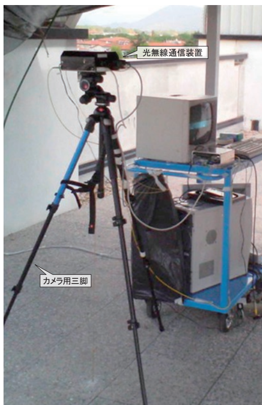
図4 サンタナ大学通信研究所の屋上に設置した光無線通信装置
