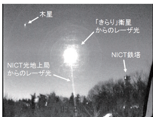
図3 世界初の低軌道衛星-地上局間の光通信実験
