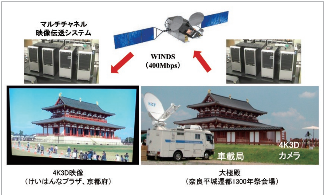
図5 WINDS衛星を用いた4K3D映像ライブ伝送実験 (2010/11/2)
