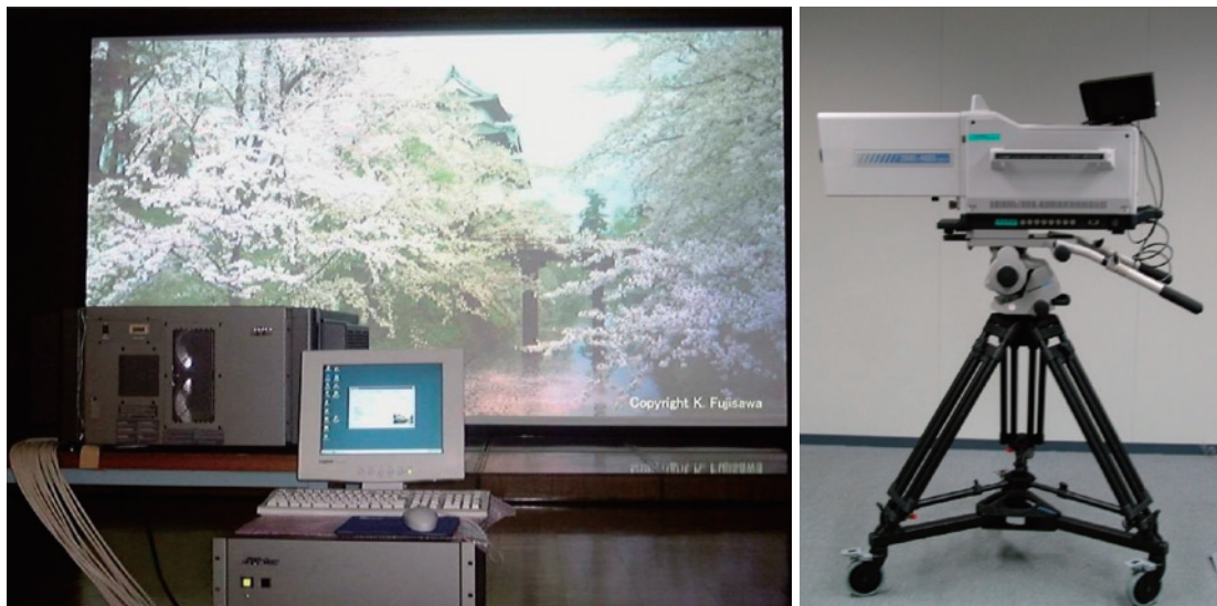
図1 4K超高精細映像プロジェクタ(左)と4Kカメラ(右)(どちらも世界1号機)
