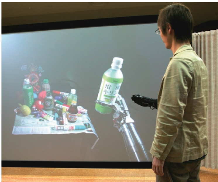
図3 4Kロボットビジョンの撮像映像 (3D操作グローブを用いて遠隔操作)
