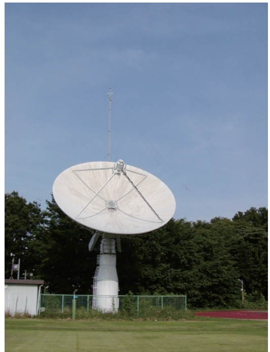
図2 ACE衛星からのリアルタイム太陽風データを受信しているNICTのアンテナ
