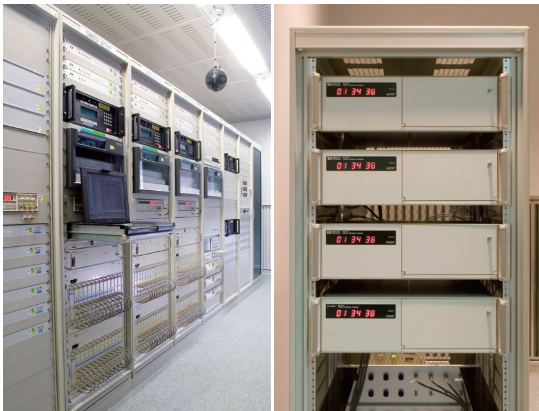
図1 日本標準時システム(左)と日本標準時生成に使われるセシウム原子時計(右)
