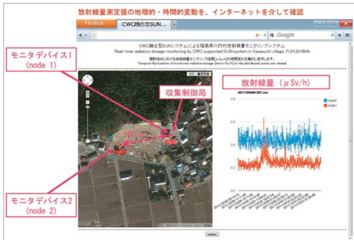
図4 SUNの動作画面 上: (a) ガスメータの自動検針 下: (b) 放射線量モニタリング
