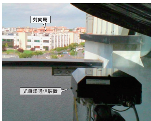
図5 サンタナ大学通信研究所から対向局を見た伝送路の様子
