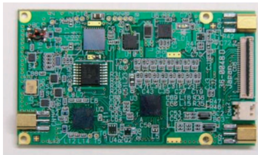
図5 再構築可能無線機(左: 高周波部、右: 信号処理部)
