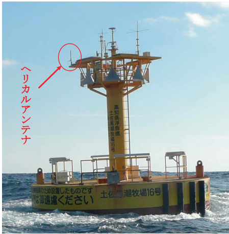
図 11 海上ブイ外観及びアンテナ取付け状況
