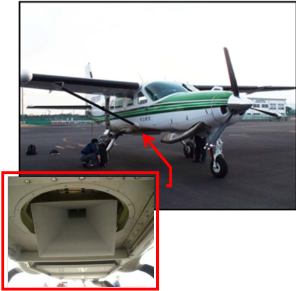
図4 測定に使用した航空機と受信用ホーンアンテナ
