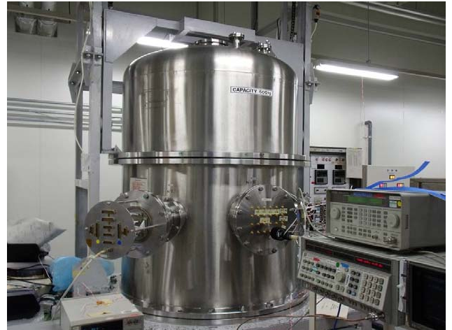
図 24 熱真空試験系セットアップ (中央は真空チャンバー)
