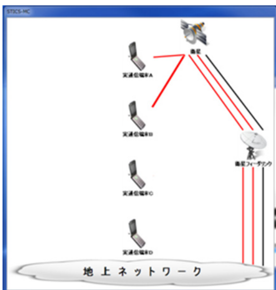
図 29 輻輳時の通話 (総合ネットワーク監視管理装置) (輻輳時：優先端末)
