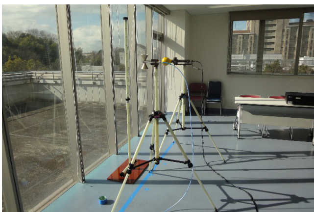
図 21 小型 3 軸等方性電界プローブ（奥）と広帯域アンテナ（手前）
