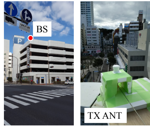
図4 送信基地局 (左) 建物外観 (右) 送信アンテナ (Copyright (C) 2017 IEICE, [3] Fig.4)
